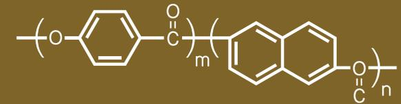
Die mechanischen Eigenschaften von Vectran, wie seine Zugfestigkeit und sein Zugmodul sind vergleichbar mit Kevlar, wogegen seine Retentionskraft und die Kriechfestigkeit unter Last etwas niedriger ist. Bei niedrigen Temperaturen zeigt das Material jedoch bessere Leistungen. Vectran gewinnt mit abnehmenden Temperaturen sogar zunehmend an Stärke, wohingegen die Zugfestigkeit von Kevlar ab -20 °C abnimmt.
